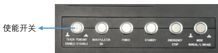
图 7-6 示教器使能开关位置
